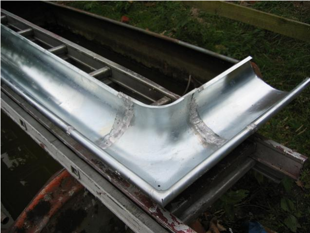
Abbildung: Der Rinnenwinkel wird angelötet
